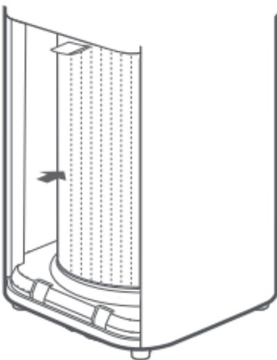
Instale el filtro en su posición con la correa del filtro en la parte superior, luego cierre el compartimento del filtro.
