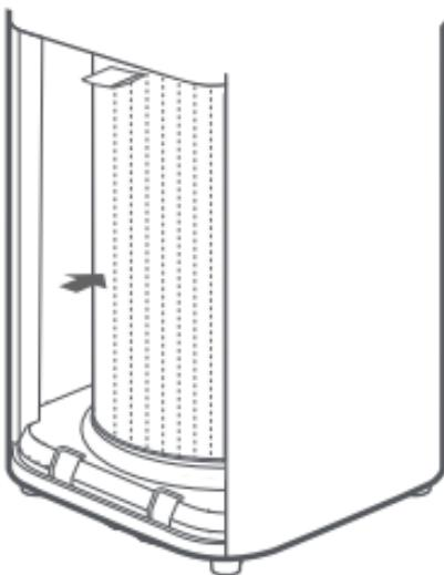
Bringen Sie den Filter mit dem Filterband oben in Position und schließen Sie dann das Filterfach.
