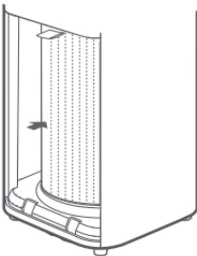
Установите фильтр на место так, чтобы ремешок фильтра находился сверху, затем закройте отсек для фильтра.
