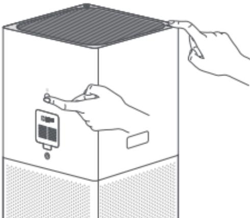
Gdy oczyszczacz znajduje się w trybie gotowości, równocześnie naciśnij i przytrzymaj przycisk zasilania i przycisk wł./wył. wyświetlacza, znajdujące się na tylnej powierzchni oczyszczacza, przez 7 sekund. Po pomyślnym resecie filtra oczyszczacz wyemitemuje dwa dźwięki.
