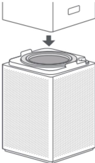
Installieren Sie den Filter im Filterfach und setzen Sie dann das obere Fach des Luftreinigers wieder ein.
