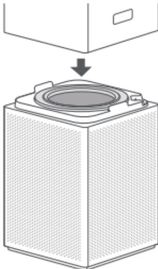
Installare il filtro nel vano filtro, e poi rimettere il vano superiore del depuratore.
