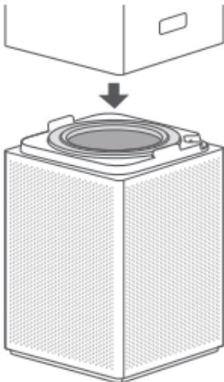
Zamontuj filtr w przegrodzie filtra, a następnie umieść z powrotem górną przegrodę oczyszczacza.
