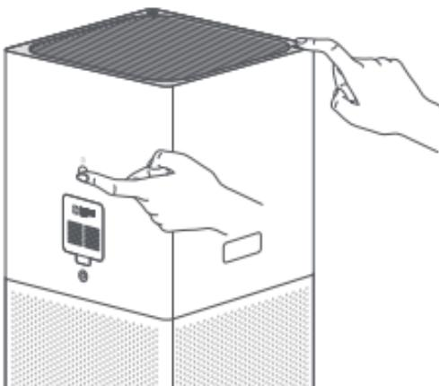
Mientras el purificador está en modo de espera, mantenga pulsados simultáneamente el botón de encendido y el botón de encendido/apagado de la pantalla en la parte posterior del purificador durante 7 segundos. Una vez que el filtro se haya restablecido correctamente, el purificador emitirá dos pitidos.
