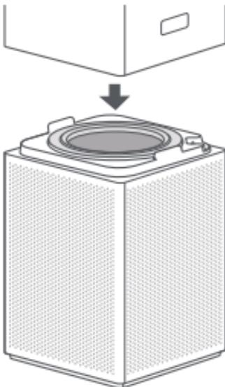
Instale el filtro en el compartimento del filtro y vuelva a colocar el compartimento superior del purificador.
