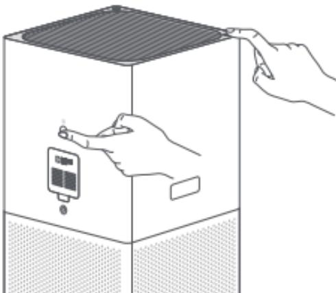
Halten Sie im Standby-Modus des Luftreinigers gleichzeitig die Ein-/Aus-Taste und die Anzeige-Ein/Aus-Taste auf der Rückseite des Luftreinigers 7 Sekunden lang gedrückt. Sobald der Filter erfolgreich zurückgesetzt wurde, gibt der Luftreiniger zwei Pieptöne ab.
