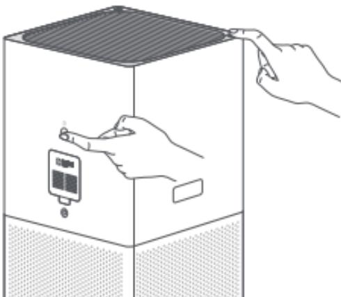
กดปุ่มเปิดปิดเครื่องกับปุ่มเปิด/ปิดหน้าจอบนด้านหลังของเครื่องฟอกอากาศค้างไว้พร้อมกันเป็นเวลา 7 วินาทีเมื่อเครื่องฟอกอากาศอยู่ในโหมดสแตนบาย เมื่อรีเซ็ตไส้กรองเครื่องฟอกอากาศเรียบร้อยแล้ว เครื่องฟอกอากาศจะส่งเสียงดังบีบสองครั้ง
