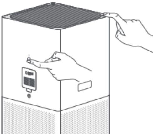
Когда очиститель находится в режиме ожидания, одновременно нажмите и удерживайте кнопку питания и кнопку включения/выключения дисплея на задней панели очистителя в течение 7 секунд. После успешного сброса фильтра, очиститель издаст два звуковых сигнала.
