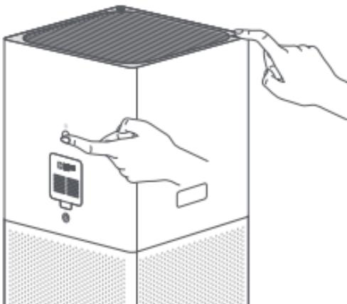
Lorsque le purificateur est en attente, maintenez simultanément enfoncés le bouton d'alimentation et le bouton d'activation/désactivation de l'affichage à l'arrière du purificateur pendant 7 secondes. Une fois que le filtre est reconfiguré avec succès, le purificateur émettra deux bips.
