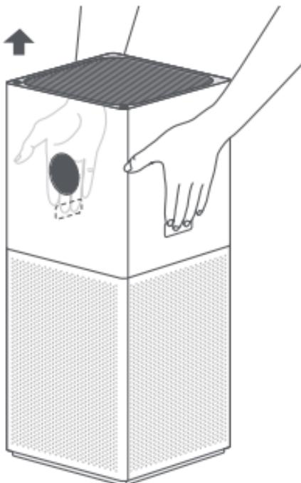
Maintenez enfoncés les boutons de déclenchement avec vos deux mains et soulevez le compartiment supérieur du purificateur.
