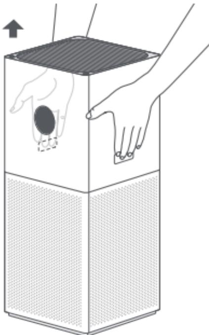
Drücken und halten Sie die Entriegelungstasten mit beiden Händen und heben Sie das obere Fach des Luftreinigers an.
