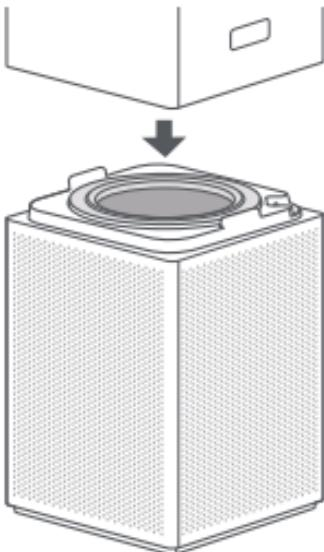
Установите фильтр в отсек для фильтра, а затем поместите обратно верхний отсек очистителя.
