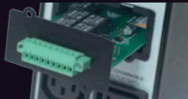
Für die Kommunikation mit IBM AS400-Server oder zur Einbeziehung in industrielle Schaltanlagen kann ZINTO um eine optionale AS400- / Relaiskarte ergänzt werden. An ihrer Klemmleiste stehen potenzialfreie Meldekantakte (via Relais) folgender Funktionen zur Verfügung: Normalbetrieb, Batteriebetrieb, Batteriespannung niedrig, Bypassbetrieb, Standbybetrieb, Sammelstörung. Über einen zusätzlichen Eingangskontakt kann die ferngesteuerte USV-Abschaltung erfolgen.
