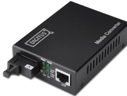
**Gigabit Ethernet Medienkonverter, Singlemode, BiDi Tx1310nm / Rx1550nm, SC connector, bis zu 20km**
